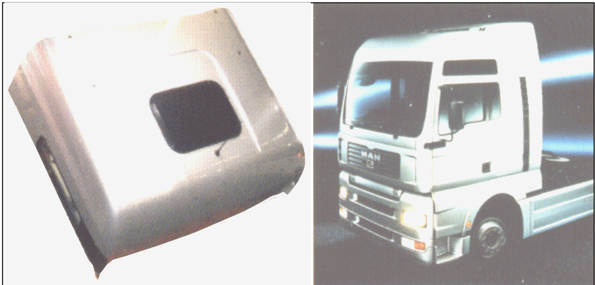
Bild 2.13: LKW-Hochdach, hergestellt im RTM-Verfahren [47]
