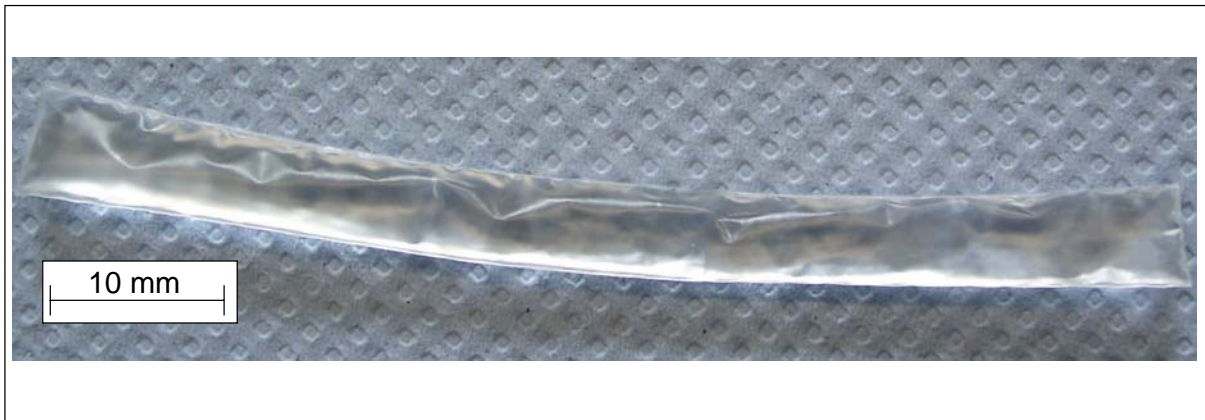
Bild 5.2: Bild einer typischen Probe zur Schrumpfmessung, hier: flüssiges EP-Harz
