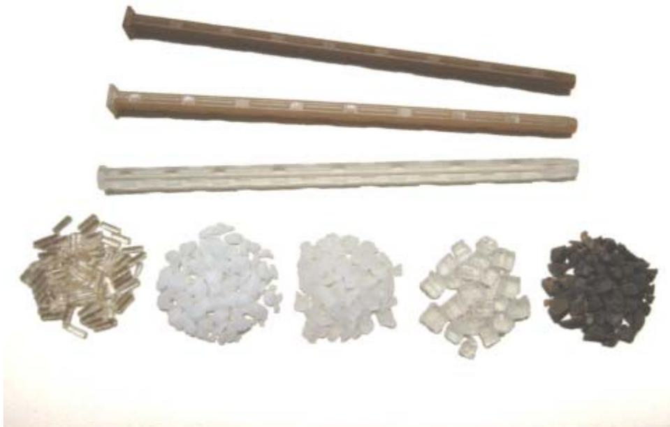
**Bild 5.1:** Die Knochennägel von oben nach unten: MFC-PGA/PLA 30:70, MFC-PGA/PLA 10:90 und reines PLA. Die biodegradierbaren Granulate von links nach rechts: PLA, PLLA, PLDLLA, PDLLA (niedrigschmelzende Matrixwerkstoffe) und PGA (hochschmelzende, verstärkende Komponente).
