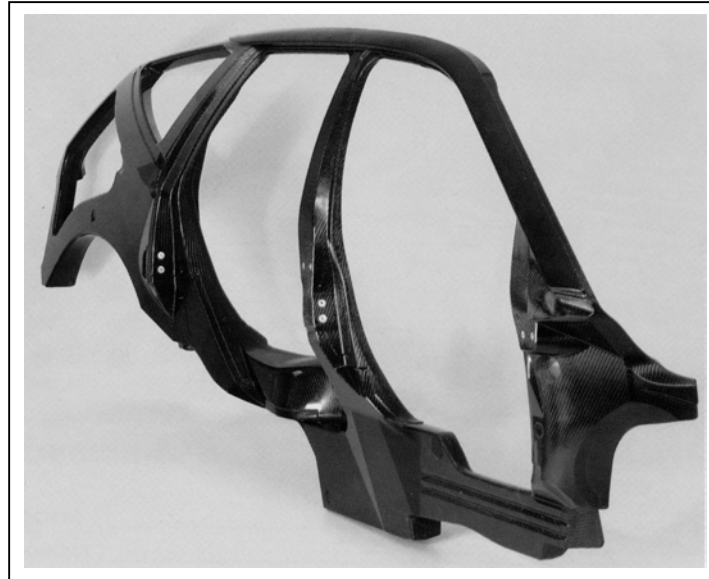
Bild 1.2: Technologieträger Z22: Seitenrahmen aus kohlenstoffaserverstärktem Kunststoff (CFK) [3]
