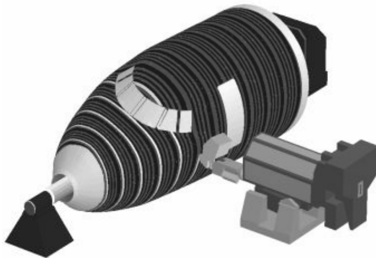
Bild 1.3: Vision für die Herstellung einer Cockpitsektion mit dem Thermoplast-Tapelegeverfahren [8]
