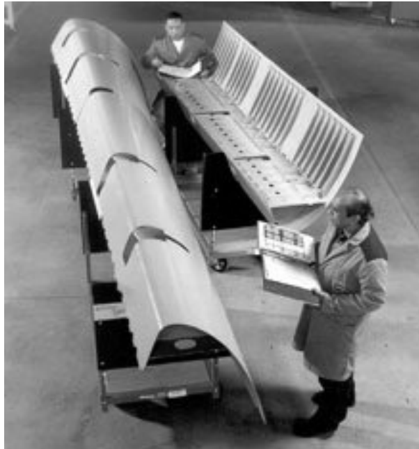
Bild 1.2: Feste, widerstandsgeschweißte Flügelvorderkante des A340-500/600 mit GF-PPS-Komponenten, Stork/Fokker, Niederlande, 2001, [5]
