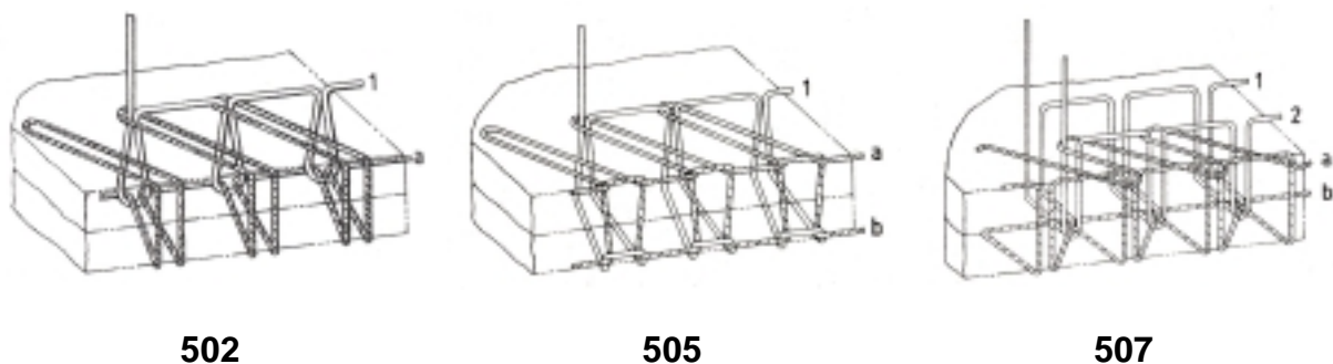
Bild 4-7: Mögliche Überwendlichstichvarianten (Unterklassen 502, 505 und 507) nach ISO 4915
