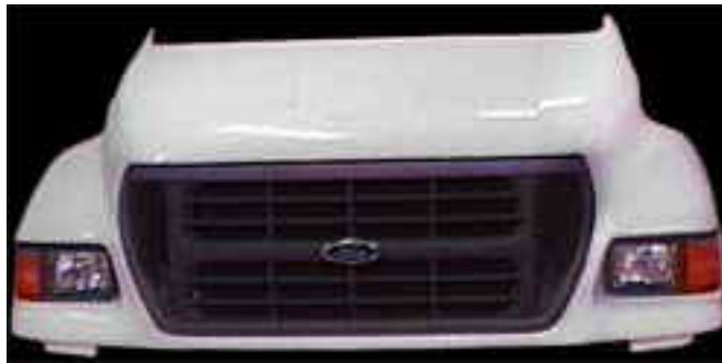
Bild 1-6 LKW-Frontpartie mit integrierten Kotflügeln und Kühlergrill [37]
