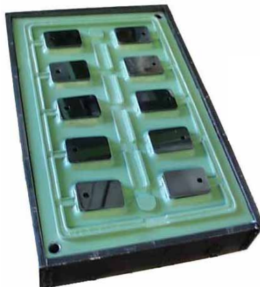
Bild 2-5 Silikon-VARTM-Mehrfachwerkzeug mit Linienanguss, umlaufendem Steiger und polierten Metalleinsätzen zur Fertigung oberflächenschöner Bauteile
