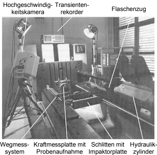
Bild 3.2: Crashprüfstand mit Hauptkomponenten [79]
