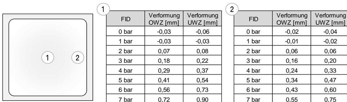
Abbildung 3.15: Durchbiegung des Acrylglases in Folge von Durchströmung mit Druckluft.
