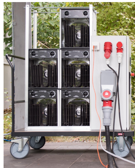
Abbildung 15.3: Lastnachbildung: Schematische Darstellung der Lastansteuerung (links) und Last-Simulator mit 75 kWp (rechts)
