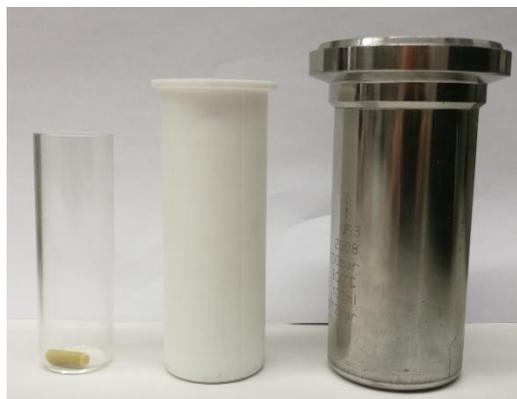
**Abbildung 164:** Für die Hydrierung von Acetophenon verwendetes Glasgefäß mit teflonbeschichtetem Magnetrührstab, Teflonhülle und Reaktorboden.
