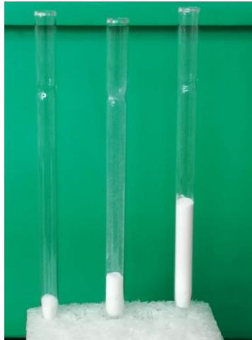
**Abbildung 162: Aufbau der verwendeten Pasteurpipetten (von links nach rechts) mit Watte, mit Watte und Magnesiumsulfatmonohydrat und fertige Handsäule inklusive neutralem Aluminiumoxid.**
