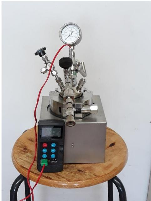
**Abbildung 163:** Für die Hydrierung von Acetophenon verwendeter Batch-Reaktor der Firma Berghof.
