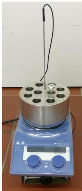
Abbildung 161: Magnetrührer mit Aluminiumblock, Thermoelement und verschlossenem Rollrandgläsern.
