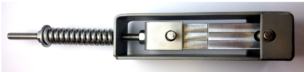
Abb. 4.8: Spannvorrichtung zur Alterung von Zugscherproben unter Zuglast [89].
