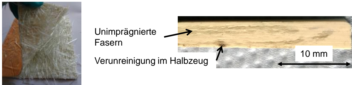
Abbildung 3.13: Mangelhafte Imprägnierung eines SMC-Halbzeuges (50x50 mm 2 ) (links) führt zu Fehlstellen im SMC-Probekörper (rechts)
