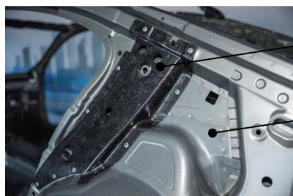
Abbildung 2.3: rCF-C-Säule „Verstärkungsblech“ im Rohbau des BMW G11 (7er) [43]
