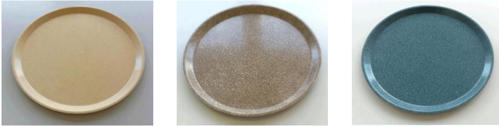
Abbildung 2.13: Öko-BMCs der Firma Lorenz [111] mit verschiedenen Verstärkungsfasern; links: Sisal, mittig: Jute, rechts: Baumwolle (Jeans)
