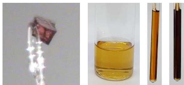
Abbildung 28: Fotoaufnahmen von [(\eta^5-C_5Pr_5)Cr(\eta^5-C_5H_5)] ( 4 ) von links nach rechts: 1.) Kristall; 2.) unter Argon, gelöst in Pentan; 3.) unter Argon, gelöst in C_6D_6 ; 4.) nach kurzzeitiger Lufteinwirkung, gelöst in C_6D_6 .
