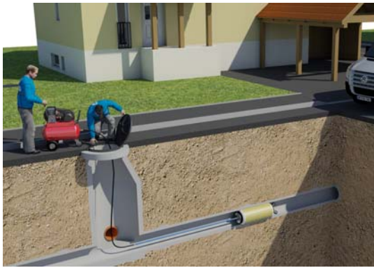
(a) Schema der Applikation eines GFK-Kurzliners [4]
