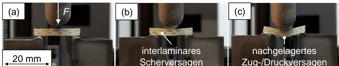
Abb. 4.62: Versuchsdurchführung zur Ermittlung der interlaminaren Scherfestigkeit \tau mit (a) unbelasteter Probe (b) interlaminaren Scherversagen und (c) nachgelagerten Zug-/Druckversagen
