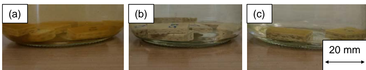
Abb. 4.67: Bilder nach Auslagerung von ILSS-Proben in wässrigem Medium, Probekörper (a) GF/3P-W1, (b) GF/2P-15ELO und (c) GF/2P-15ELO-1WE3110
