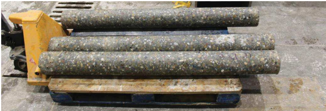
Abb. 7.28 Bohrkern mit h/d \approx 1500/150 mm
