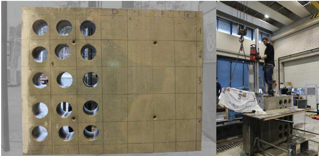
Abb. 7.27 Wand nach der Bohrkernentnahme
