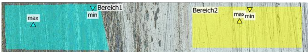
Abb. 123: Ausgewählte Bereiche zur Ermittlung der Stufenhöhe zwischen Bereich 1 (Tribofilm) und Bereich 2 (Referenzoberfläche 100Cr6) nach p_v = 4 \text{ MPa m/s} Untersuchung.
