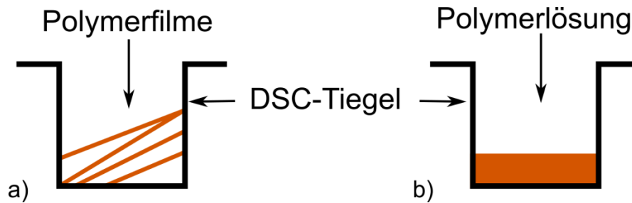
Abb. 47: DSC Probenpräparation a) DSC-Tiegel gefüllt mit Polymerfilmen, b) DSC-Tiegel mit Polymerlösung, die anschließend bei definierten Tempertemperaturen getempert wird.
