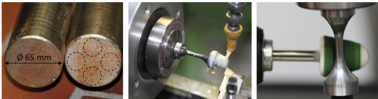
Abb. 3.3: Probenherstellung; Zuschnitt des Stangenmaterials (links), CNC-Drehen mit Übermaß (mitte), mechanische Endpolitur nach dem CNC-Rundschleifen (rechts)
