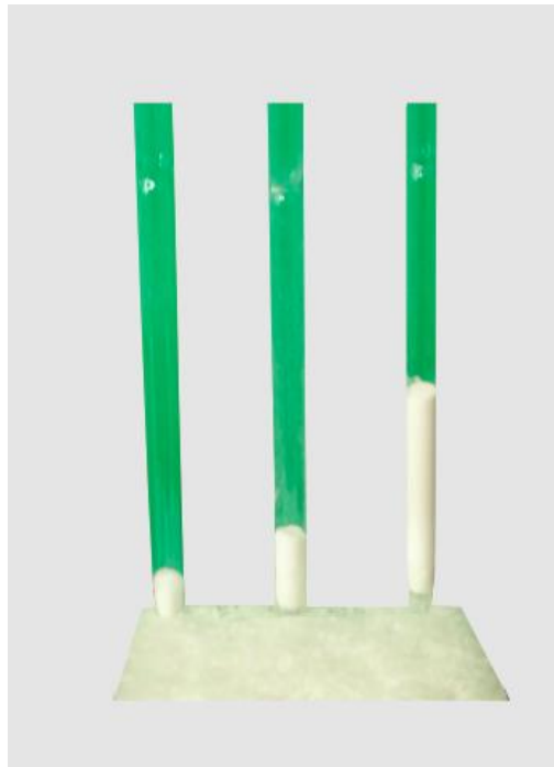
Abbildung 5.2: Pasteurpipetten mit Filtermaterialien zur Aufbereitung der GC-Proben.
