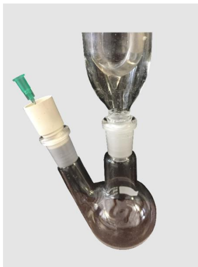
Abbildung 5.6: Zweihalskolben mit Septum und eingeführter Kanüle sowie Rückflusskühler.
