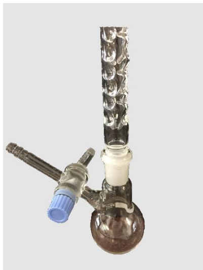
Abbildung 3.22: Kolben mitsamt Vigreux-Kolonne als offenes Reaktionsgefäß.
