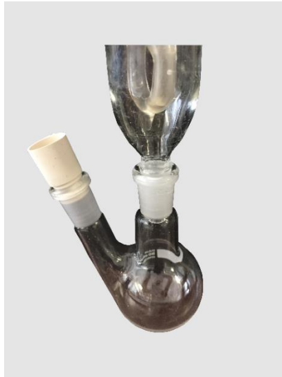
Abbildung 5.5: Zweihalskolben mit Septum und aufgesetztem Rückflusskühler.
