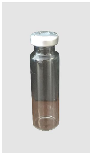
Abbildung 3.19: Rollrandglas als geschlossenes Reaktionsgefäß.
