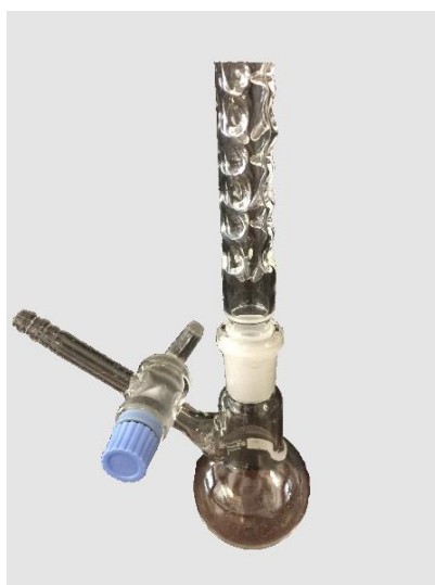
Abbildung 5.4: Schlenkkolben mit aufgesetzter Vigreux-Kolonnen.
