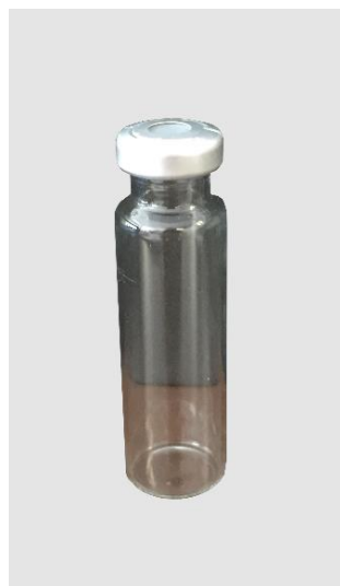
Abbildung 5.3: Rollrandglas mit Bördelkappe und teflonbeschichtetem Septum.
