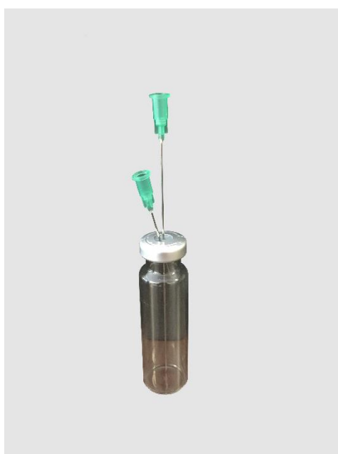
Abbildung 5.7: Verschlossenes Rollrandglas mit zwei eingeführten Kanülen.
