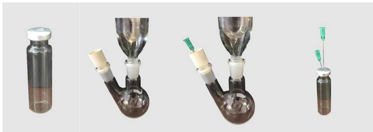
Abbildung 3.26: Reaktionsgefäße zur katalytischen Transferhydrierung mit Ethanol.
