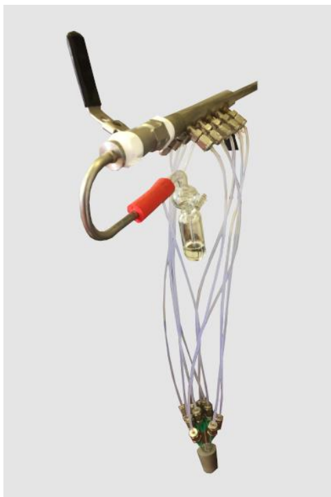
Abbildung 5.9: Vakuum- und Inertgasverteiler zur Durchführung von Parallelreaktionen.
