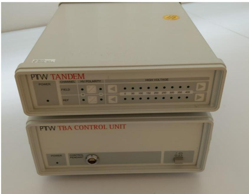
**Abbildung 4:** TANDEM-Elektrometer mit TBA Control Unit
