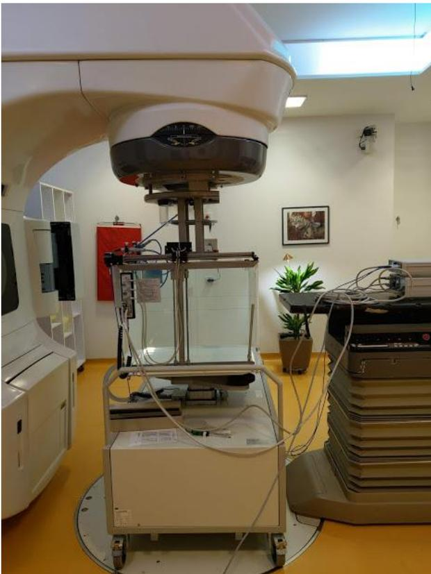
**Abbildung 13:** Messaufbau für Tiefendosiskurven
