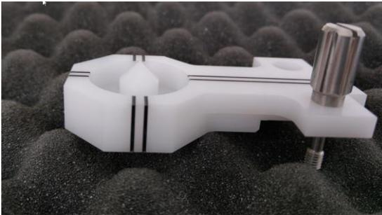
**Abbildung 12:** TRUFIX pointing device mit cone point
