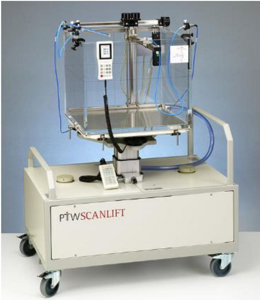
**Abbildung 3:** MP3-M Wasserphantomsystem PTW Freiburg [PTW Da]
