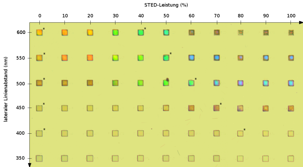
Abbildung 4.13: Woodpiles mit der bottleshape -Mode. Lichtmikroskop-Aufnahme (Auflicht) photonischer Kristalle mit nach unten sinkendem lateralem Linienabstand ( a ) bei nach rechts steigenden bottleshape -Abregungsintensitäten (0 - 15,9 mW). Bis zu 450 nm erzeugen die woodpiles bei geeigneter STED-Leistung sichtbare Effekte. Die mit (*) markierten Strukturen werden im Folgenden spektral untersucht.
