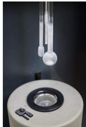
Abbildung 3.5: Verwendete Apparatur Autosorb-1 zur Messung der Stickstoff-physisorptions Isothermen.
