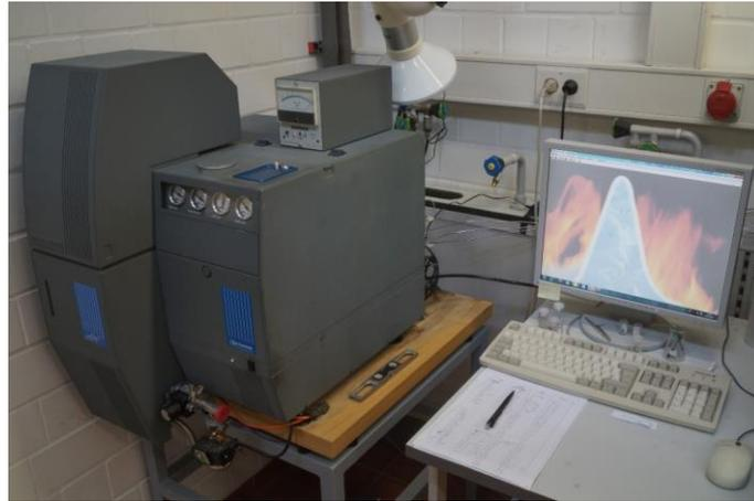
*Abbildung 3.10: Apparatur vom Typs Setsys 16/MS der Firma Setaram zur Messung der thermogravimetrischen Analysen.*
