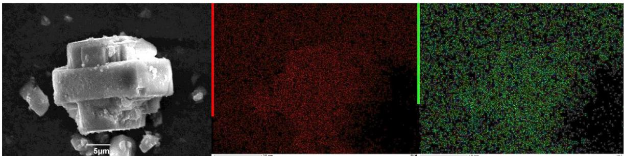
Abbildung 5.11: Graphische Darstellung der energiedispersiven, röntgen-spektroskopischen Aufnahmen von Zeolith Pt/Sn-HZSM-5 ( $\text{Si}/\text{Al} = 40$ ) und einer Beladung von Platin (rot) und Zinn (grün) von jeweils 0,25 Gew.-%.
