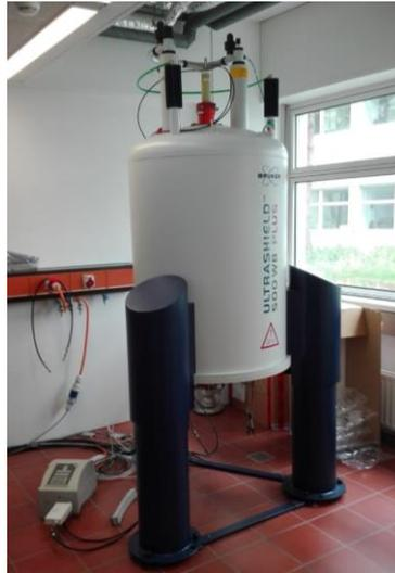
Abbildung 3.9: Festkörper-Kernspinresonanzspektrometer Bruker Avance II 500 SOLID STATE NMR.
