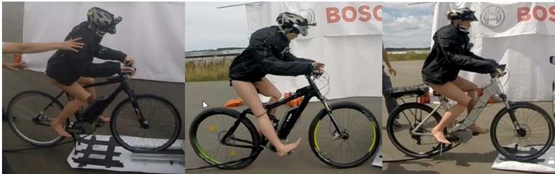
Abbildung 3.10: Crashtest-Pedelegs inklusive Fahrer-Dummy und Beschleunigungsvorrichtung
