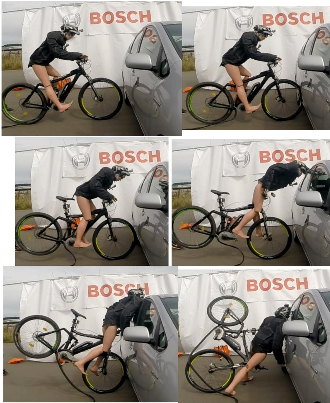
Abbildung A.3: Crash-Szenario seitlicher Aufprall auf PKW mit 20 km/h
