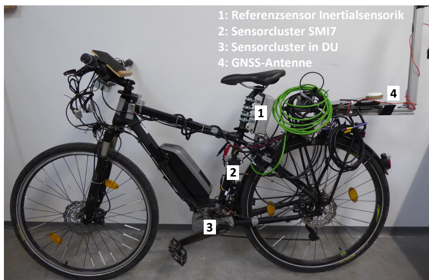
Abbildung 3.8: Messfahrrad mit Sensorpositionen
