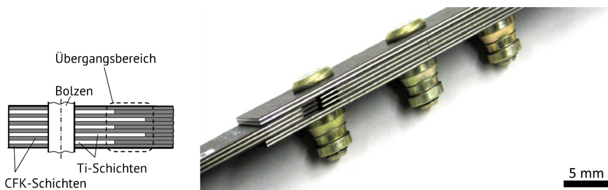
Abbildung 2-2: Bolzenverbindung aus CFK/Titan-Laminaten für Anwendungen in der Luftfahrt [18]
