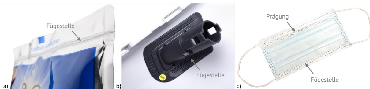
Abbildung 2-7: Kunststoff-Ultraschallgeschweißte Verbindungen a) eines Getränkebehälters (Polyester/Al/Polyethylen), b) einer Halterung für eine Scheinwerferreinigungsanlage im Auto (Polpropylen (Heidi Ochs, Sonotronic Nagel GmbH, persönliche Mitteilung, 18.08.2020) und c) einer Gesichtsmaske (Bänder: Polyester 85% und Spandex 15%, Maske: Polypropylen (Stephanie Hübner, Ampri mbH, persönliche Mitteilung, 07.07.2020)), (a und b mit freundlicher Genehmigung der Sonotronic Nagel GmbH)
