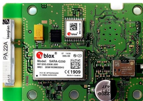
Abbildung 4.31: Die Platine der AMRA-Box, für die LDLTE implementiert wurde.
