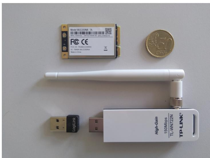
Abbildung 4.3: Verschiedene WLAN-Adapter: Eine Complex WLE200NX mini PCIe (fullsize) Karte (oben), ein Logilink WL0084B USB-Adapter (unten links) und ein TP-Link TL-WN722N USB-Adapter (unten rechts)
