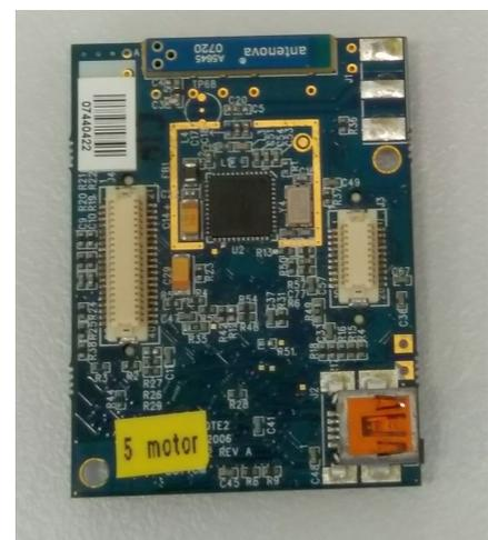
(b) Unterseite mit CC2420-Transceiver (Mitte oben) und Antenne (oben)
