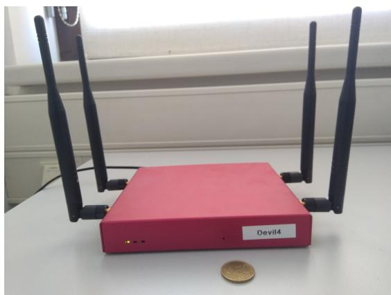
(b) Ein PC Engines APU2 Knoten mit vier Antennen. Im Gehäuse sind zwei Comex WLE200NX mini PCIe-Karten verbaut und jeweils mit zwei Antennen verbunden.
