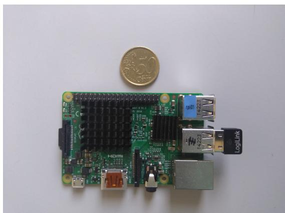
(a) Ein Raspberry Pi 2 Model B mit einem Logilink WL0084B USB-Adapter.
