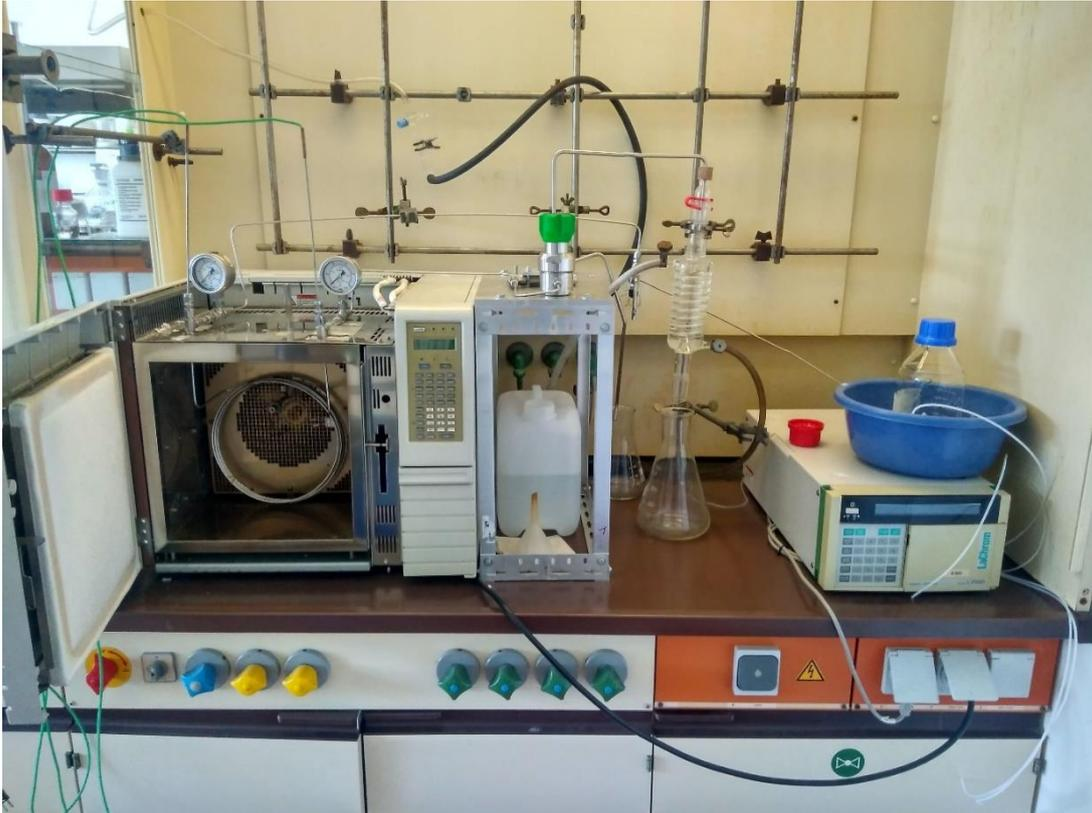
**Abb. 131** Aufbau A des Rohrreaktors mit GC-Ofen und 1/4 Zoll Rohr.
