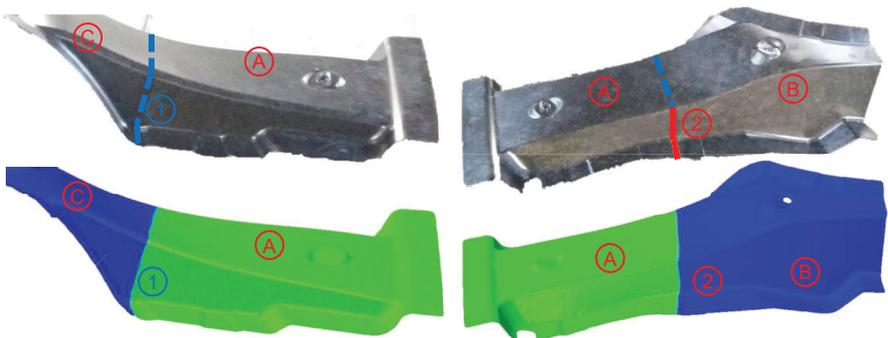
**Abbildung 9.10:** Vergleich der Bindenahtposition (Variante 2) im Versuch und Simulation bei der Stütze C-Säule für HUP-REC
