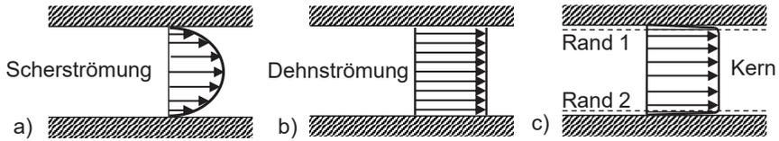
**Abbildung 2.2:** Modellannahmen für Strömungsprofile für SMC mit a) Reine Scherströmung (Generalisiertes Hele-Shaw-Modell [34]) b) Reine Dehnströmung (Wandgleitendes Quetschmodell [34]) und c) 3-Schichtmodell (Dehnströmung mit hydrodynamischer Wandreibung) als heute wesentliche Modellannahme für SMC
