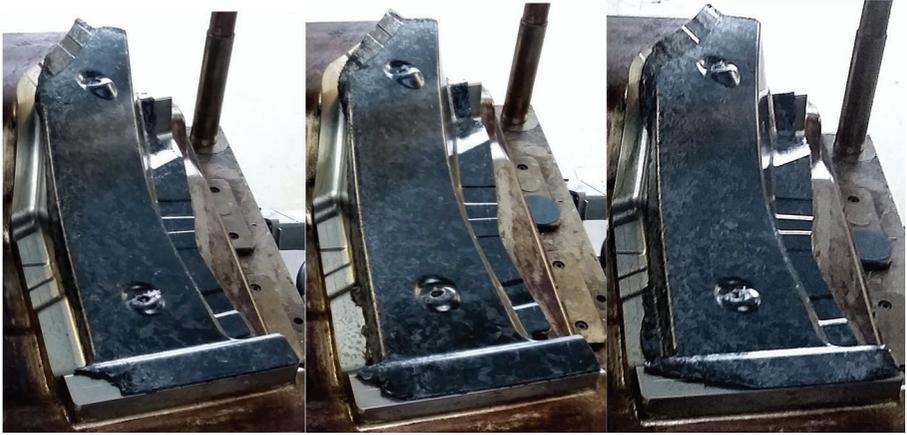
**Abbildung A.11:** 1 mm-Short-Shots für AMC8590 bei  $\dot{h} = 0,5$  mm/s für Variante 1 aus Abbildung 9.3
