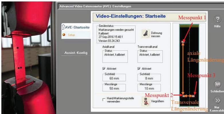
**Abbildung 3.5:** Ermittlung der Längs- und Querdehnung auf einer Universalprüfmaschine der Firma Instron GmbH mit Videoextensometer: Punktmarker auf Zugstab (links), Messung des Abstandes der Punkte mittels Instron-Software (rechts) nach [193]
