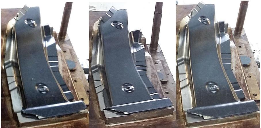
**Abbildung A.12:** 1 mm-Short-Shots für HUP-REC bei  $\dot{h} = 3$  mm/s für Variante 1 aus Abbildung 9.3
