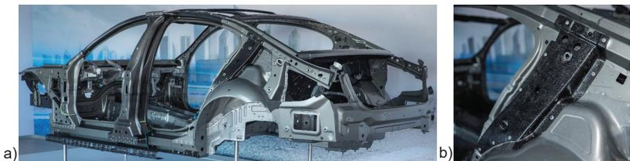
**Abbildung 1.1:** Fahrzeugkarosserie des BMW 7er [3] in Mischbauweise mit a) Carbon Core und b) Stütze C-Säule aus C-SMC
