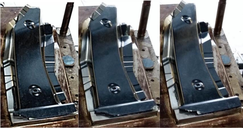
**Abbildung A.13:** 1 mm-Short-Shots für HUP-REC bei  $\dot{h}_i = 0,5 \text{ mm/s}$  für Variante 1 aus Abbildung 9.3
