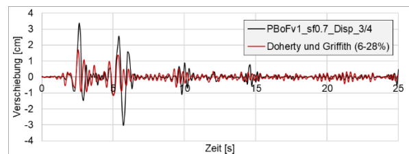
Abbildung 4.57: Verformungsverlauf für den EMS und Versuch PBoFv1_sf0.7
