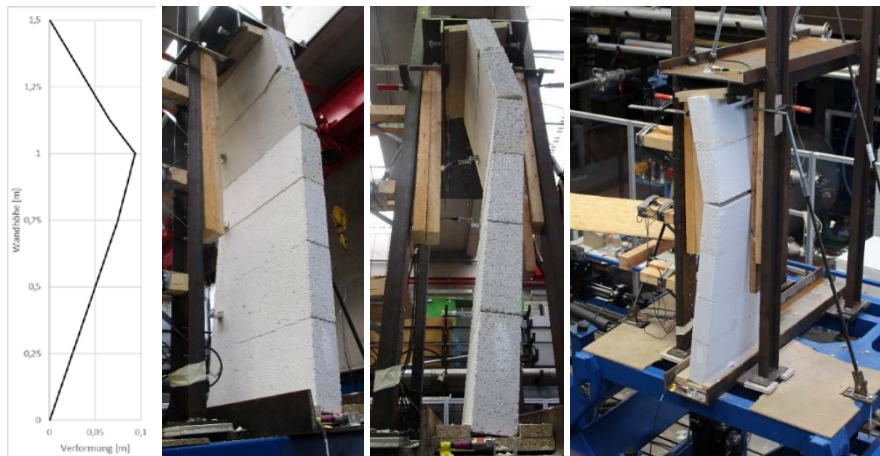
Abbildung 4.53: Versagte Wand in PBoFv1_sf0.95_1
