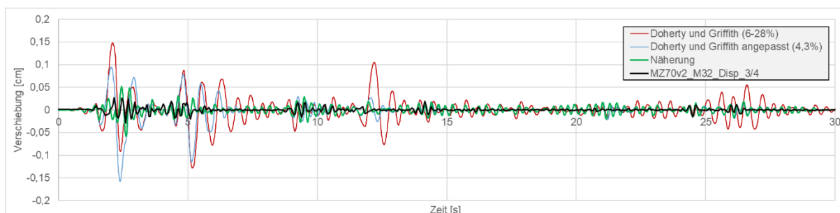
Abbildung 4.46: Vergleich der Verformungen des EMS für unterschiedliche Federkennlinien und des Versuchs MZ70v2_sf3.0_It3
