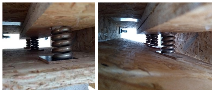
Abbildung 5.13: Federelemente zur Berücksichtigung der vertikalen Steifigkeit
