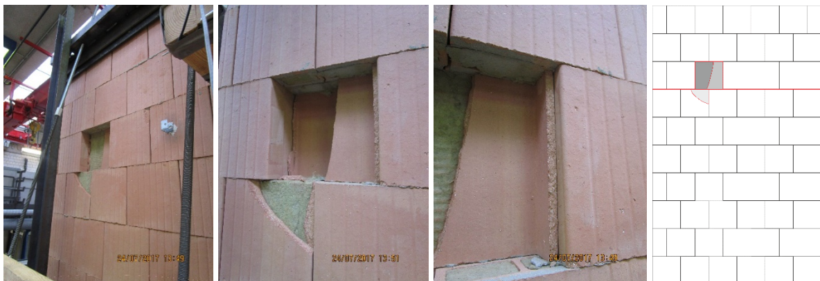
Abbildung 4.28: Ausbrüche der Ziegelsteine in MZ70v1
