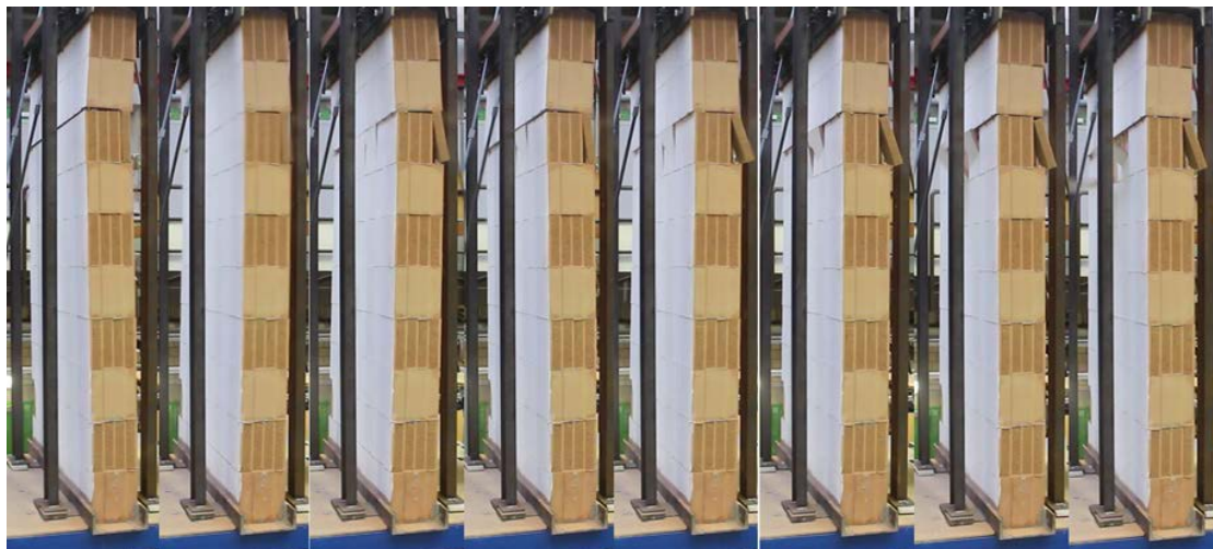
Abbildung 4.39: Verschieben des oberen Wandteils in MZ70v2_sf3.0_It4
