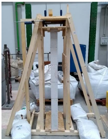
Abbildung 5.12: Versuchsstand für Pushover-Versuche
