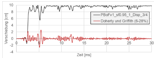
Abbildung 4.58: Verformungsverlauf für den EMS und Versuch PBoFv1_sf0.95_1
