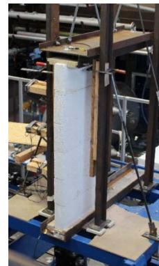
Abbildung 4.50: Versuchsaufbau mit Porenbetonsteinwand
