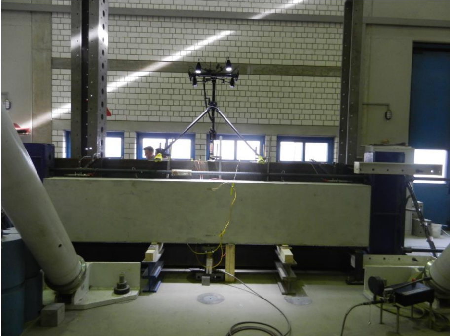
Abb. 4.8: Sandwichwand im Prüfstand im Labor für konstruktiven Ingenieurbau der TU Kaiserslautern vor Beginn des Versuchs
