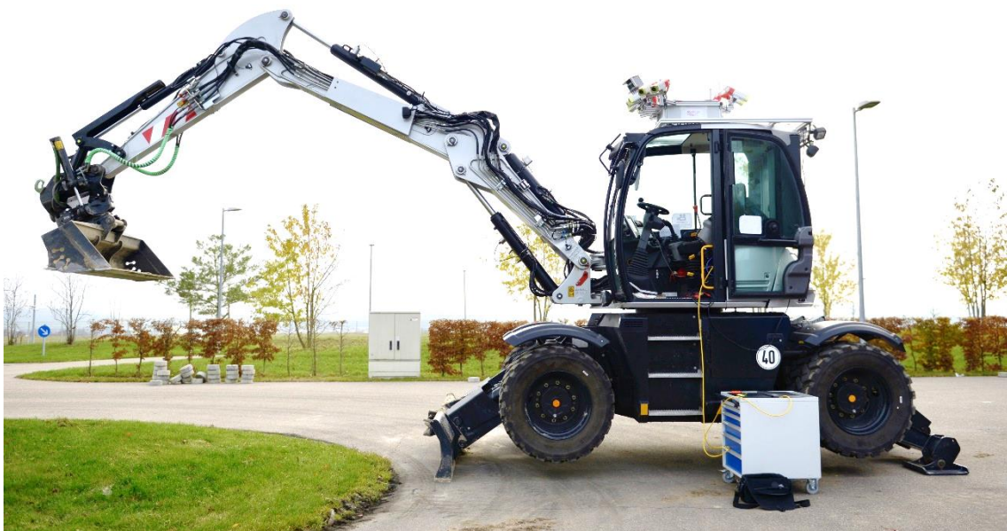
Abbildung 2.7: Der Mobilbagger Hydradig 110W des Herstellers JCB . Aus [ZANT19].
