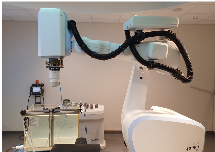
Abbildung 3.1: Messaufbau: Messung der Outputfaktoren mit Diodendetektor und Wasserphantom am Cyberknife VSI
