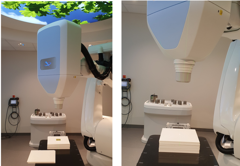
Abbildung 3.2: Messaufbau Messung Outputfaktoren mit radiochromischem Film. Links: Plattenanordnung und Filmebene. Rechts: Gesamter Aufbau.
