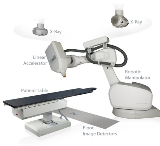
Abbildung 2.5: Cyberknife © VSI System: 6-Achsen-Roboter mit Linearbeschleuniger, Patiententisch, 2 Röntgenröhren an der Decke sowie zugehörige Detektoren im Boden [1].
