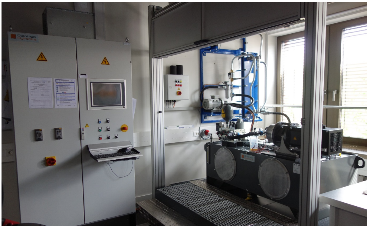
Abbildung 5.1.1: Messeinrichtung Pumpenprüfstand im Labor der AG Fluidtechnik der htwsaar
