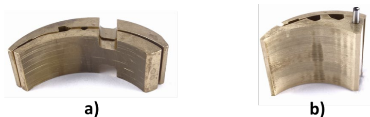
Abbildung 6.1.31: Geteilte Sichel zweier Innenzahnradpumpen mit Spaltkompensation
