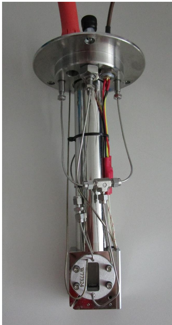
Abbildung 21: Aufnahme des inneren Aufbaus der temperierbaren Dünnschichtküvette. Der obere Teil dient als Deckel des Vakuummantels. Die Zuleitungen münden in ein T-Stück, von wo aus die Reaktionsmischung durch die Küvette geleitet wird. Die Temperierung erfolgt konduktiv über die Füllung des Kühlfingers mit vorgekühltem Medium von oben. Ein Thermoelement samt Heizwiderstand erlaubt die Temperaturkontrolle direkt an der Küvette.
