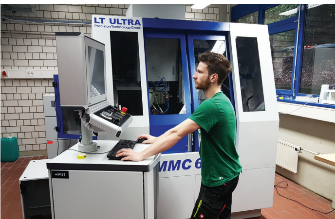
Installation des Ultrapräzisionsbearbeitungszentrums am FBK
