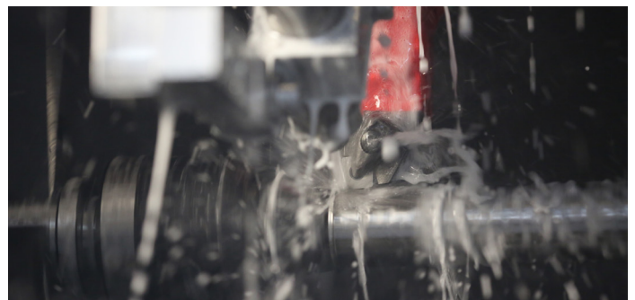
Sub-zero Kühlschmierstoffe im Einsatz für die Zerspanung von Titanlegierungen
