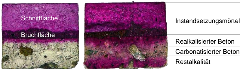
Abbildung 3-37: Prinzipskizze zur Bestimmung der Realkalisierungstiefe
