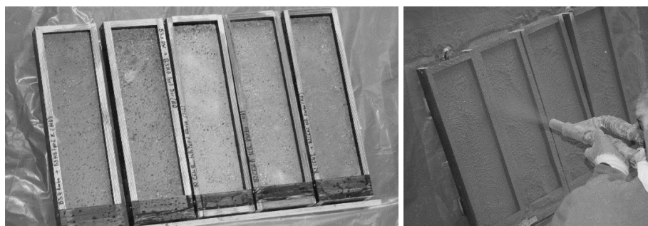
Abbildung 3-33: Herstellung der gespritzten Verbundkörper, links: eingeschalteter Untergrundbeton, rechts: Mörtelauftrag im Nassspritzverfahren
