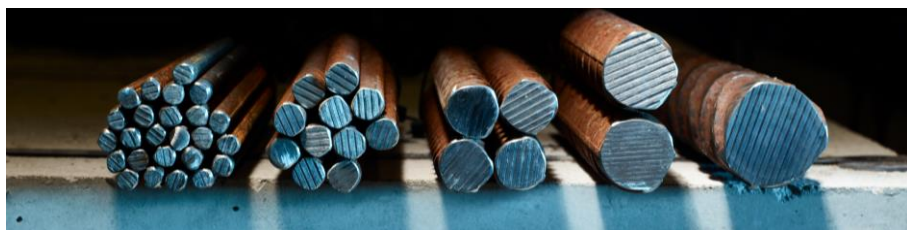
Abb. 1-1: Gegenüberstellung von Bewehrungsstäben \phi 8 mm, \phi 12 mm, \phi 20 mm, \phi 28 mm und \phi 40 mm mit jeweils annähernd gleicher Gesamtquerschnittsfläche (Foto: T. Brenner)
