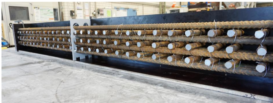
Abb. 3-5: Rissblech und Unterstüztung der Bewehrung in Bauteilmitte (Serie 1)
