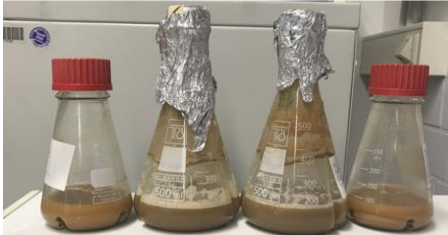
Abbildung 11: Kulturgefäße für C. uda unter aeroben (Mitte) und anaeroben Bedingungen (links und rechts); Bild: Malte Nestriepke.
