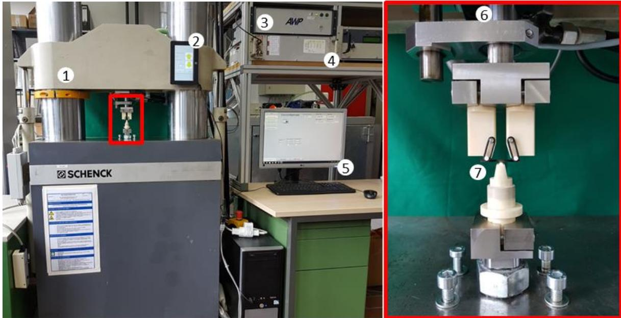
Abb. 4.2: Aufbau des servohydraulischen Prüfsystems zur Durchführung der quasistatischen Dreipunktbiegeversuche. Bezeichnung der wichtigsten Komponenten: (1) Querhaupt, (2) Fernsteuerung für den Einrichtbetrieb, (3) Maschinenregelung, (4) Messverstärker für Kraft- und Wegsignal, (5) Steuereinheit inkl. Sollwertvorgabe und Datenaufzeichnung, (6) Hydraulikzylinder und (7) Dreipunkteinspannung inkl. Biegeprobe.
