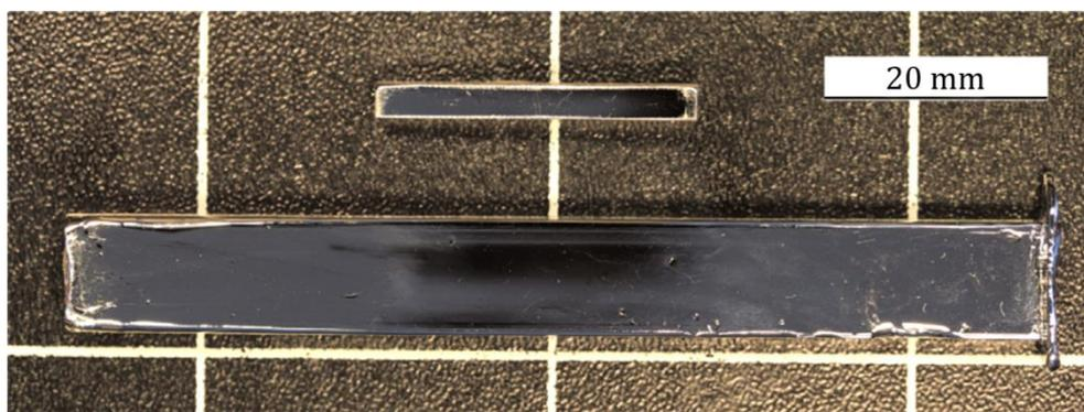
Abb. 3.1: Foto des saugvergossenen Probenmaterials der voll amorphen  $Zr_{52,5}Cu_{17,9}Ni_{14,6}Al_{10}Ti_5$  Legierung (unten) und einer unbearbeiteten Biegeprobe (oben) [11].
