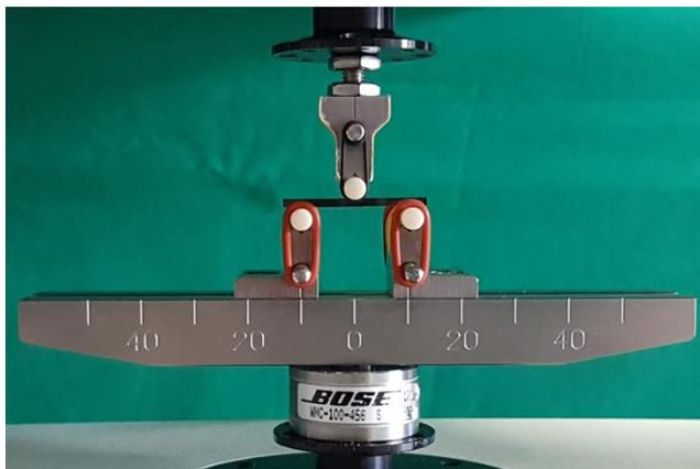
Abb. 4.3: Dreipunktbiegeeinspannung für die zyklische Materialprüfung auf dem Bose ElectroForce 3230 Prüfsystem.
