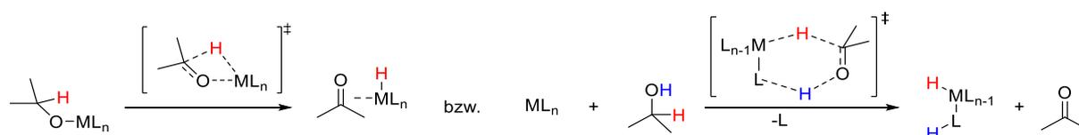
**Abb. 26:** Reaktionsschemen zum *inner sphere* Mechanismus (links) und *outer sphere* Mechanismus (rechts).<sup>[61]</sup>
