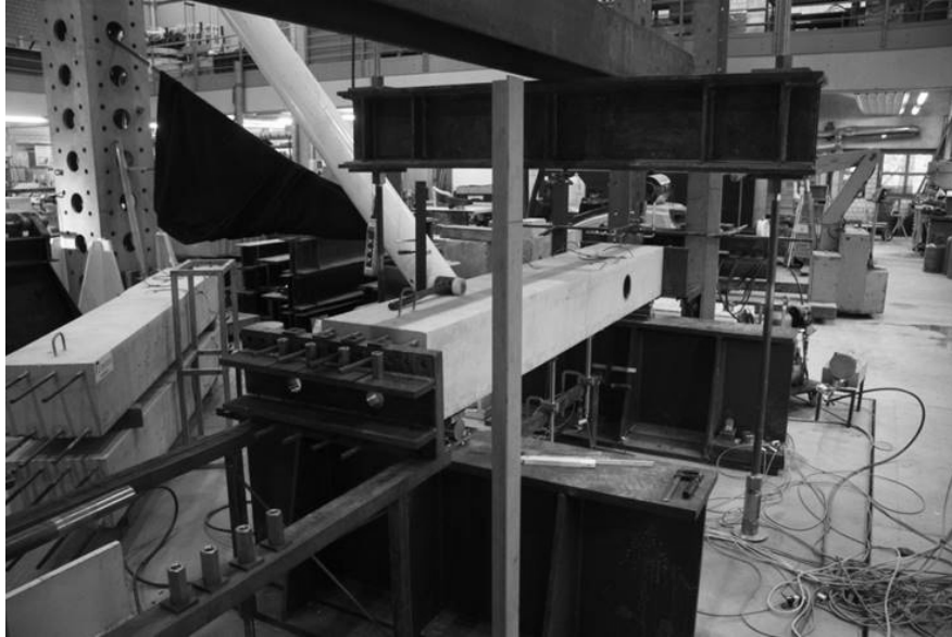
Abbildung 5.2: Versuchseinrichtung mit eingebautem Probekörper, Querkrafttraverse und Koppelplatten für die Einleitung der Zugkraft.
