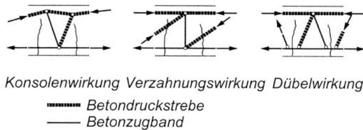
Abbildung 6.34: Mögliche Tragmechanismen zur Aufnahme der Querkraft in gerissenen Stahlbetonbauteilen ohne Querkraftbewehrung nach MUTTONI 2003.
