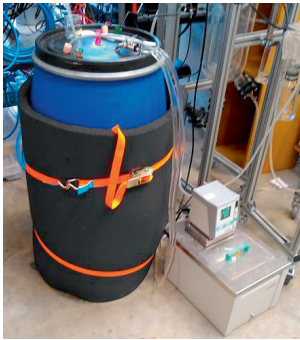
Abbildung 3-5: Versäuerungsreaktor zur VFA-Produktion
