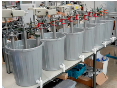
Abbildung 3-3: Versuchsaufbau der Selektion und Akkumulation, Oben: Beschreibung der Messtechnik und Armaturen; Mitte: Schematisches Fließbild; Unten von links nach rechts: Vorlage Verdünnungswasser, Vorlage VFA-Substrat, Reaktoren zur Selektion und Akkumulation
