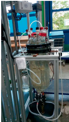
Abbildung 3-2: Reaktor zum Ausfäulen des Inokulums
