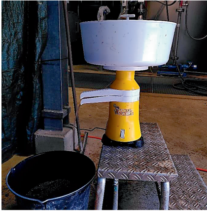
Abbildung 8-8: a) Zentrifuge zur Entwässerung eines Teils der Proben zur Untersuchung der PHA-Stabilität im Down-Streaming; b) Entwässerter Schlamm nach Zentrifugation
