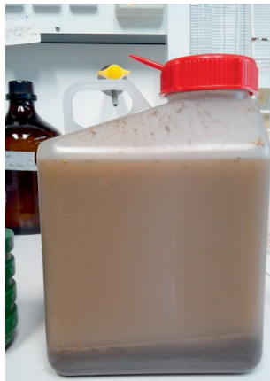
Abbildung 8-9: Überstand nach Zentrifugation mit 3.000 g eines versäuerten Primärschlammes mit einer Laborzentrifuge
