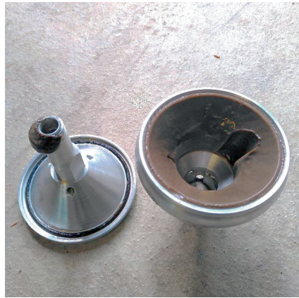
Abbildung 8-8: a) Zentrifuge zur Entwässerung eines Teils der Proben zur Untersuchung der PHA-Stabilität im Down-Streaming; b) Entwässerter Schlamm nach Zentrifugation
