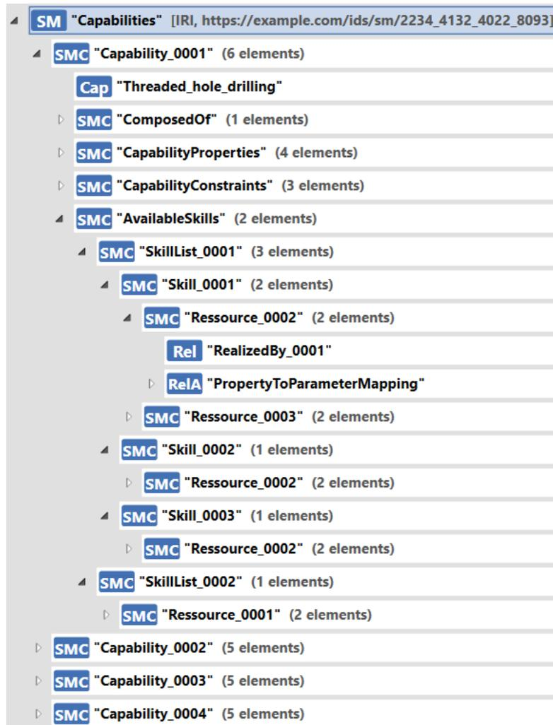
Abbildung 4.8: VWS-TM zum Sammeln von Capabilities einer Produktionsumgebung, das auf mögliche Skill-Sequenzen verweist
