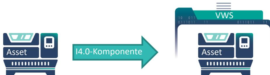
Abbildung 2.3: Darstellung eines Assets, das mit einer VWS eine I4.0-Komponente bildet
