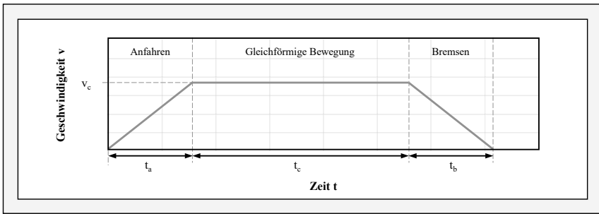
Abbildung 2-5: Typischer Geschwindigkeits-Zeit-Verlauf von Fördermitteln (nach [Arno09])
