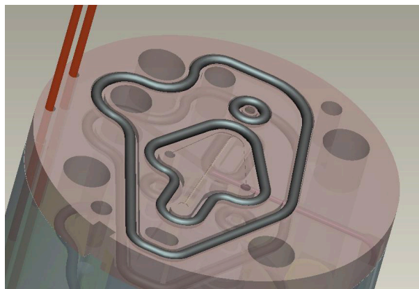
Abbildung 9: Darstellung Mischmodul mit integriertem Raupenmischer (Split/Recombine).
