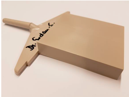
Abbildung 4.6: Spritzgegossenes Halbzeug zur Prüfkörperherstellung für die tribologische Charakterisierung der Festschmierstoffe [NGS21a]
