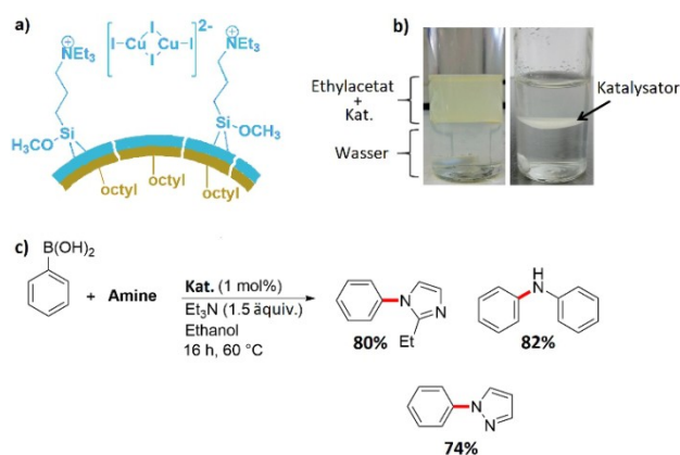
Abbildung 15. a) Aufbau des heterogenen, zweikernigen Janus-Kupferkatalysators. b) Anfängliche Suspension des Janus-Katalysators in einem zweiphasigen System aus Ethylacetat und Wasser (links) und Wanderung der Katalysatorpartikel zur Phasengrenze (rechts). Nachgedruckt und angepasst mit Genehmigung von Ref. [52]. © American Chemical Society (2021). c) Beispiele von Aminderivaten, die über die Chan-Lam-Reaktion von Phenylboronsäure und verschiedenen Aminen erhalten wurden.
