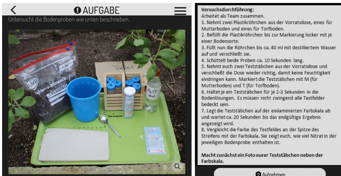
Abbildung 51: Versuchsaufbau zum Nitratnachweis bei der Station „Karnivoren“ (Screenshot aus Actionbound (zur besseren Lesbarkeit optimiert), Eigene Aufnahme, 2023)
