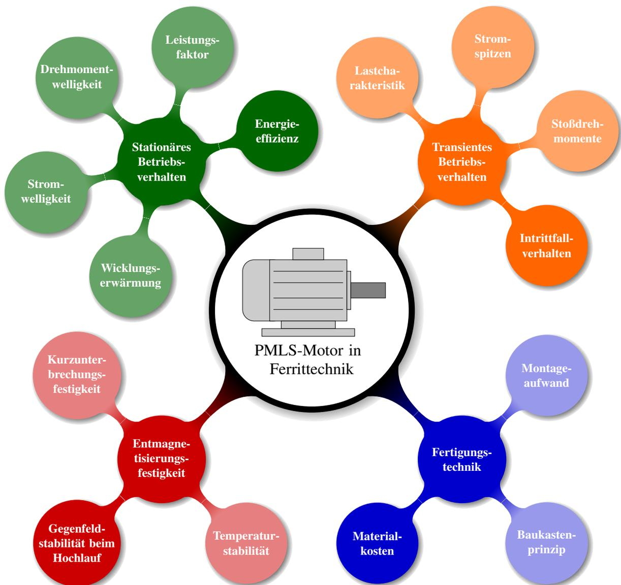
Abbildung 2.2: Anforderungen an einen PMLS-Motor in Ferrittechnik
