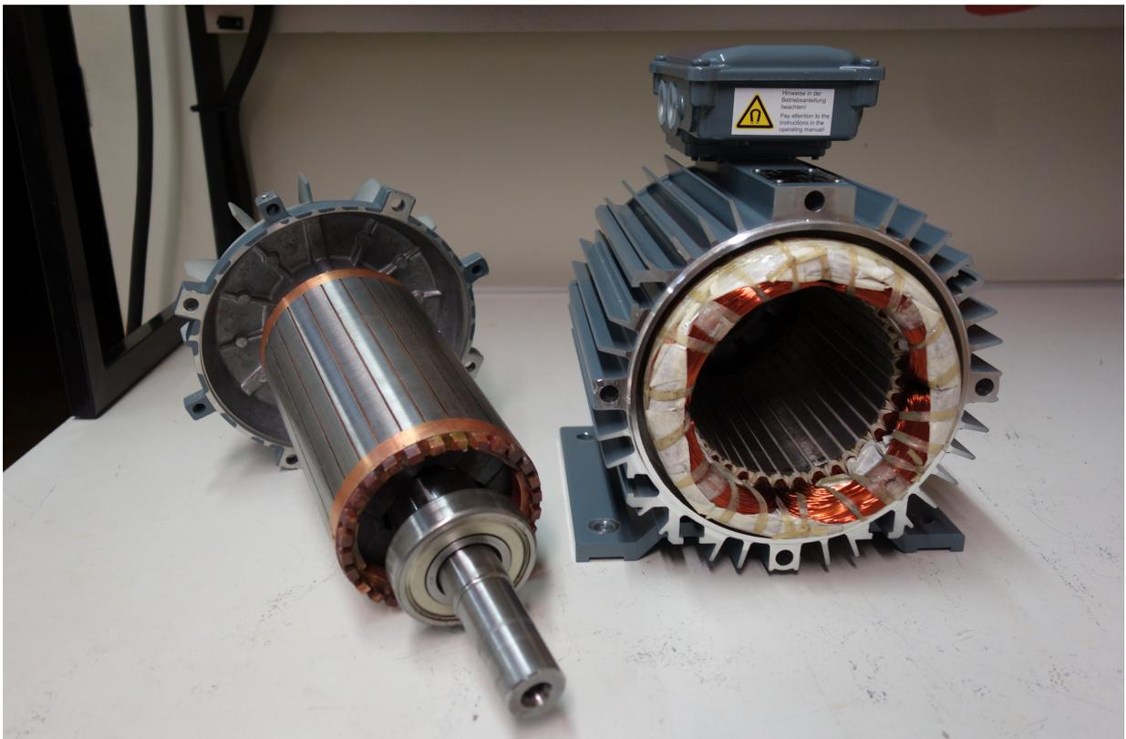
Abbildung 9.3: Stator und Rotor des V-Funktionsmusters
