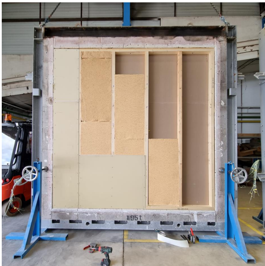
ABBILDUNG 38: ABBILDUNG PROBEKÖRPER GIPSKARTON-FEUERSCHUTZPLATTE UND HOLZFASERDÄMMUNG (BILDMONTAGE)
