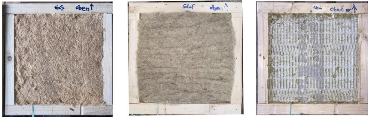
ABBILDUNG 16: PROBEKÖRPER DÄMMSTOFFVERSUCHE –(V.L.) HOLZFASERDÄMMUNG (FEST), SCHAFSWOLLE, STEINWOLLE
